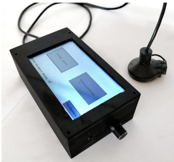
Рис. 4. Экспериментальный образец системы электронной аускультации
