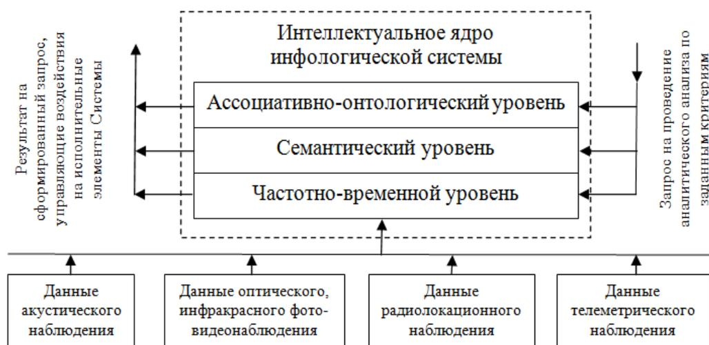
Рис. 5. Логическая схема работы интеллектуального ядра информационно-телекоммуникационной системы
