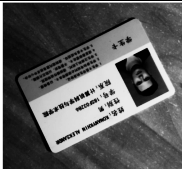
Рис. 4. Результат работы фильтра Гаусса, оператора градаций серого и повышения контраста
