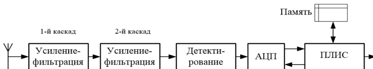
Рис. 5. Архитектура 4 модуля приема сообщений АЗН-В
