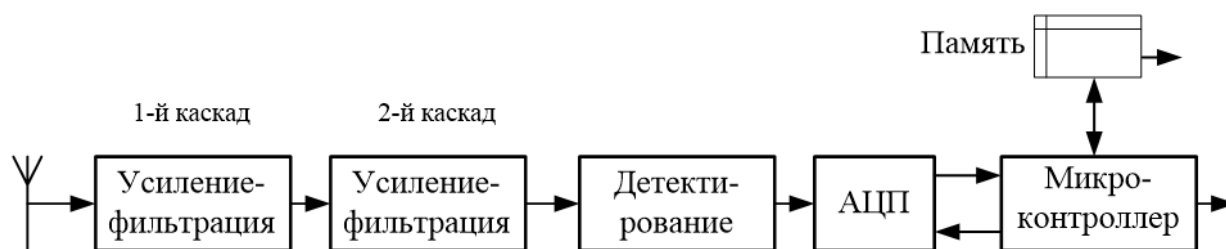
Рис. 4. Архитектура 3 модуля приема сообщений АЗН-В
