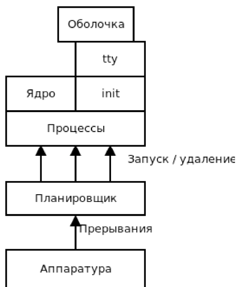
Рис. 2. Роль планировщика процессов в структуре ОС
