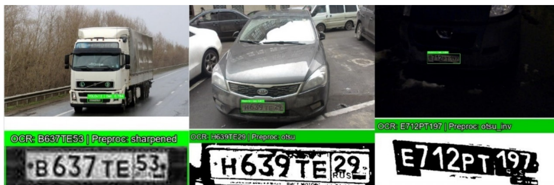
Рис. 8. Результаты тестирования реализованного гибридного метода распознавания ГРЗ ТС
