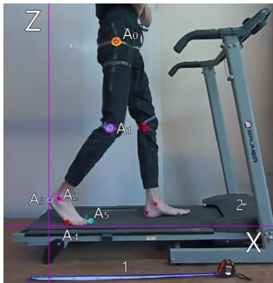
Рис. 2. Процесс видеозахвата траектории: A_0, A_1, A_2, A_3, A_4, A_5 – ключевые точки; 1 – измерительная лента; 2 – беговая дорожка
