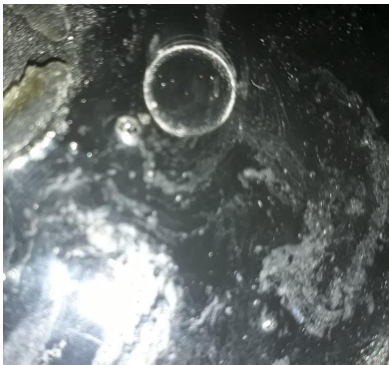
Рис. 2. Кратеры на поверхности компаунда
