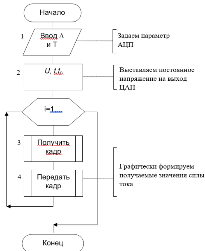
Рис. 9. Схема алгоритма получения данных посредством L-Card для поиска БАТ
