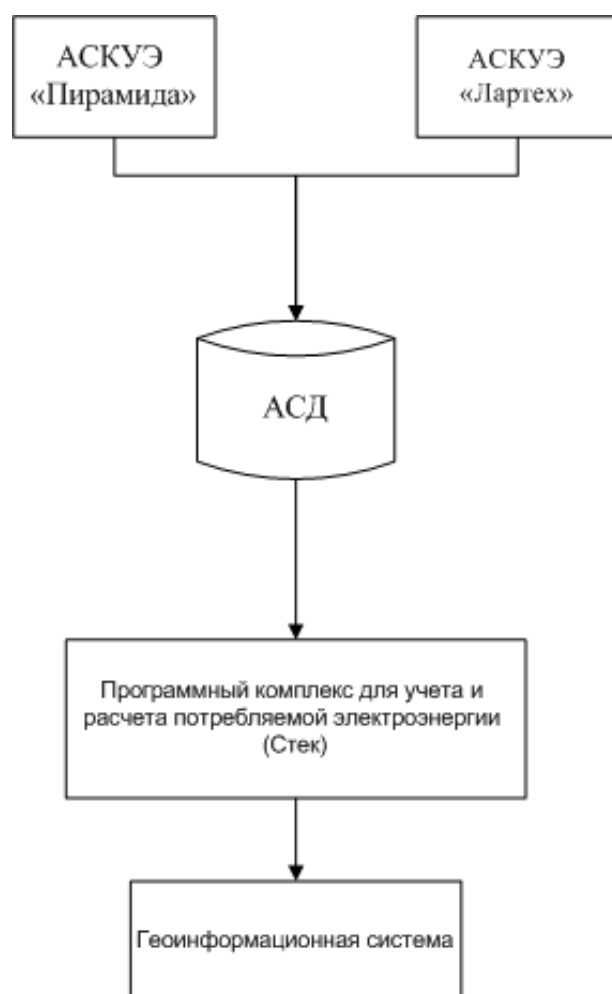
Рис. 2. Схема передачи данных в систему учета
