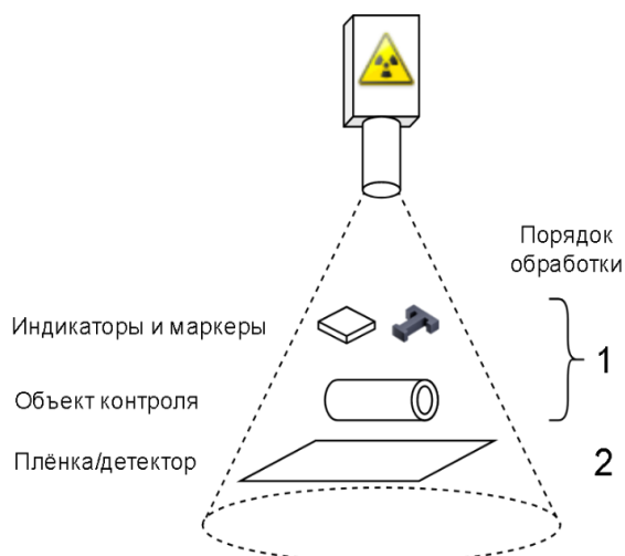
Рис. 7. Схема взаимодействия цифровых двойников при симуляции РК
