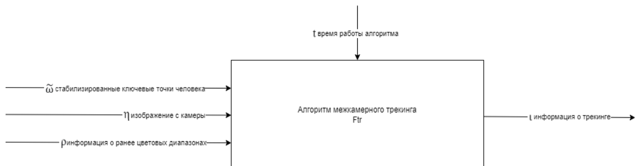
Рис. 7. Контекстная диаграмма работы алгоритма межкамерного и межкадрового трекинга
