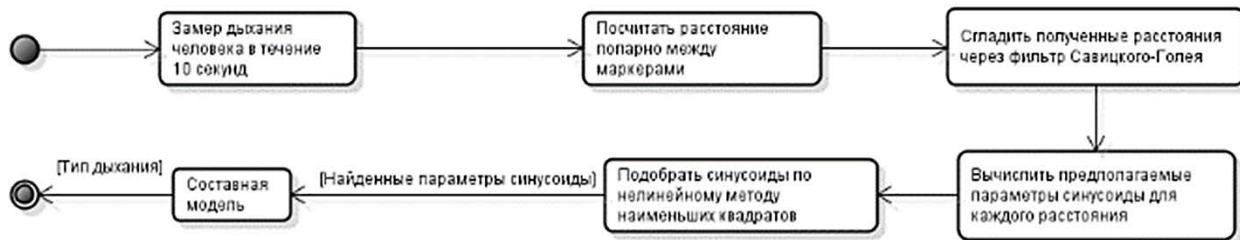
Рис. 4. Общий алгоритм определения типа дыхания с помощью подбора синусоиды
