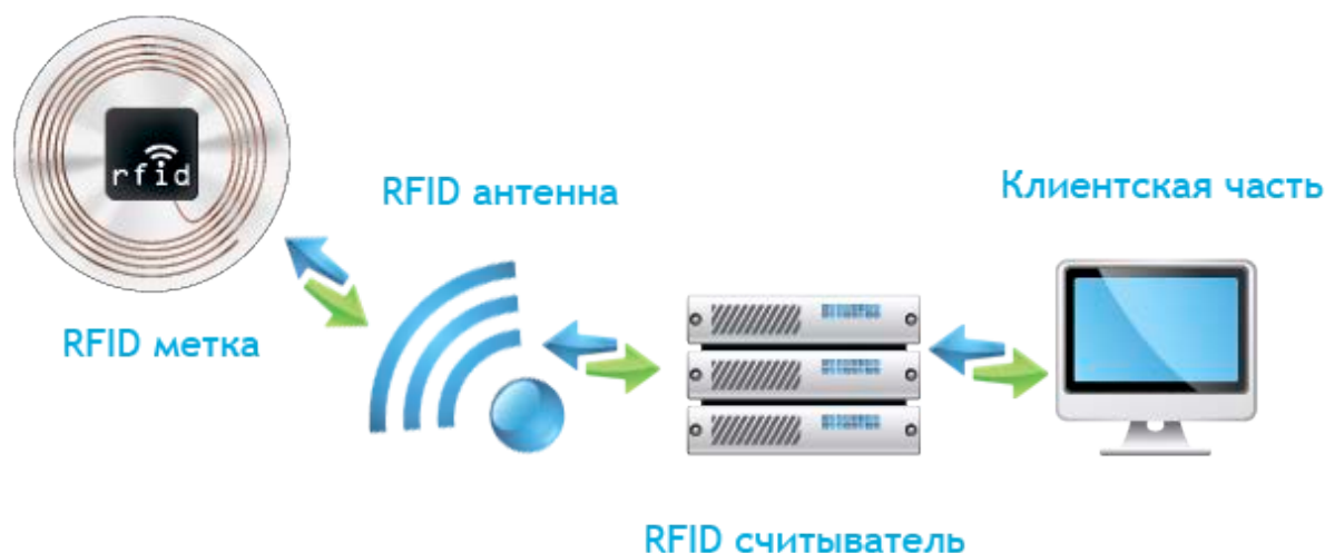
Рис. 4. Обобщенная структурная схема системы радиочастотной идентификации
