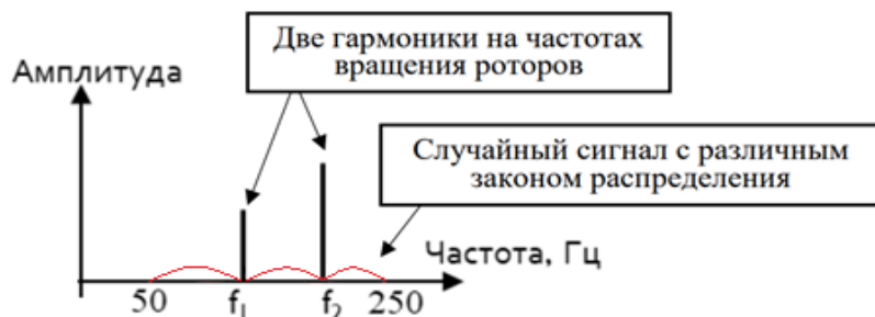
Рис. 6. Частотный спектр вибросигнала двигателя АЛ-31Ф ( f_1 , f_2 – частоты вращения ротора низкого и высокого давления)
