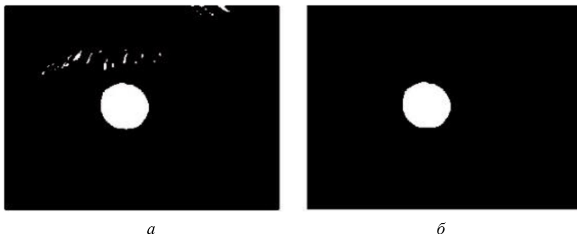
Рис. 8. Результаты обработки: а – морфологическая обработка; б – удаление бинарных артефактов Fig. 8. Processing results: а – morphological processing; б – binary artifacts removal
