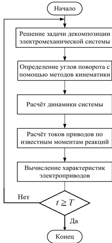
Рис. 1. Алгоритм вычисления параметров электроприводов с использованием метода декомпозиции
