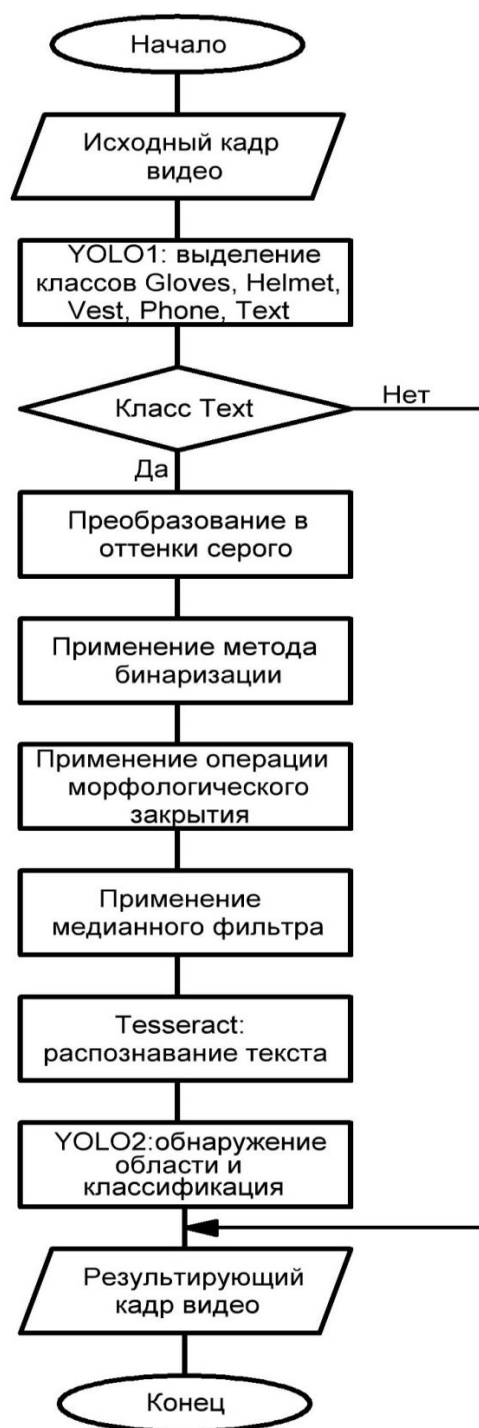
Рис. 1. Блок-схема алгоритма работы метода контроля доступа и мониторинга соблюдения техники безопасности на энергетических хозяйствах предприятий для каждого кадра видео
