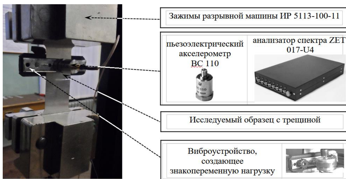
Рис. 3. Фотография испытательной установки с закрепленной пластиной
