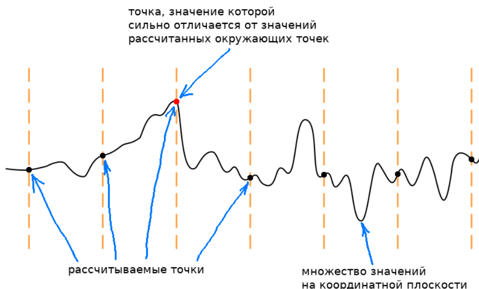
Рис. 11. Принцип появления шумов на сгенерированном изображении
